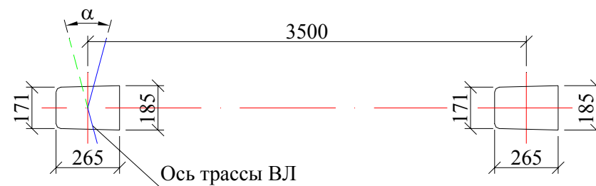
Схема установки стойки СВ95-3 (СВ95-2с, СВ95-3с)
