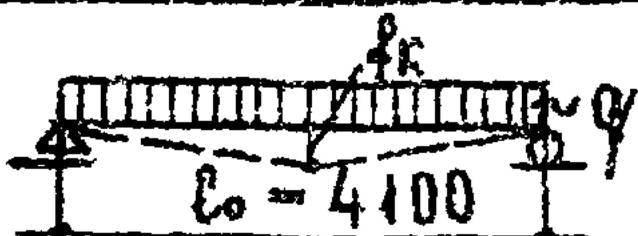
СХЕМА ОПИРАНИЯ И ЗАГРУЖЕНИЯ ПРИ ИСПЫТАНИИ (ПЛОЩАДЬ ЗАГРУЖ. 4,1x0,96м)
